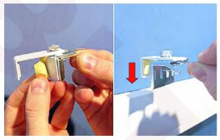
Schutzstreifen abziehen und den Haken auf den Rahmen des Fensterflügels aufschieben (mind. 2 Stk. pro Jalousie, Position der Haken an den äußersten, freien Stellen).
