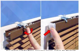
4. Den Haken auf der Rinne einrasten lassen, indem die Blockade des Hakens nach links verschoben wird. Die Blende auf beiden Seiten der oberen Rinne befestigen.
